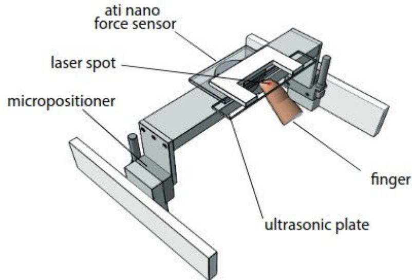
Sous l'effet des vibrations, le doigt n'est pas en contact permanent
