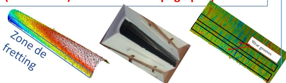
Faire un Moule D'injection pour répliquer la zone de fretting (avec écartement des tiges) puis mesurer les indicateurs d'endommagements et mesurer la topographie
