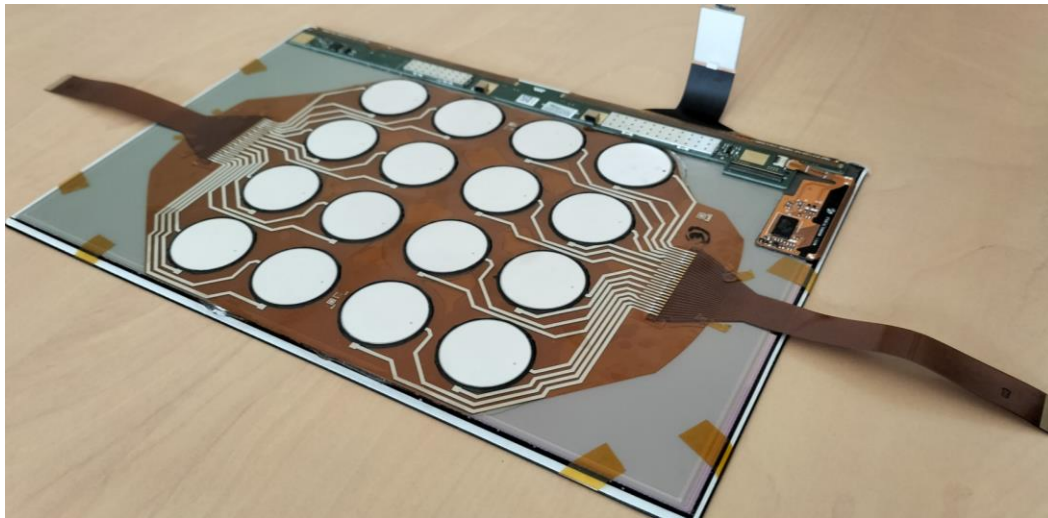
Ecran OLED équipé d'actionneurs piezoélectriques, CEA 2024
